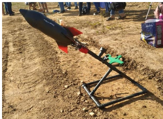
Figura 1. O gás carbônico gerado na reação se expande e pode chegar a até 125 libras de pressão, calculado por um manômetro preso ao foguete. Fonte: MOBFOG, 2022.
