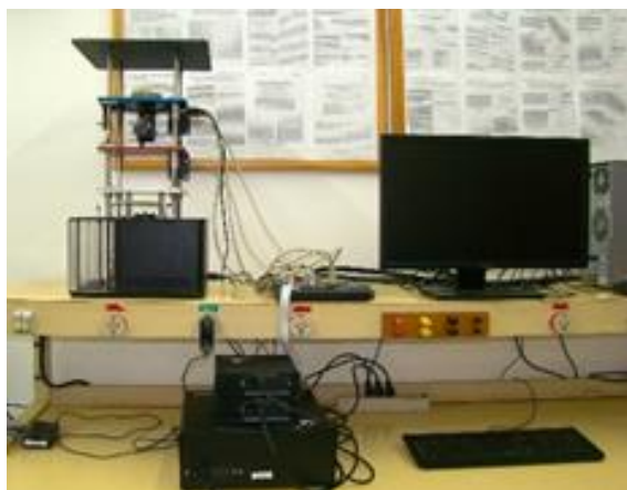
Figura 1. Sistema suspensão ativa pertencente ao LPC – UNESP-Ilha Solteira.
