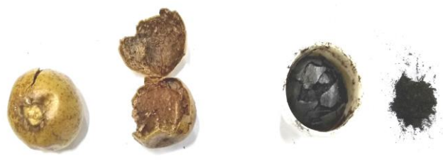
Figura 2. Carvão ativado do coco bociuiva. Da esquerda para a direita: amostra in natura , amostra desidratada (8 horas a 110°C), amostra calcinada (4 horas a 250°C) e carvão ativado (2 horas a 800°C, vapor de água).
