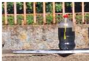
Figura 1. Instrumento spray com duas camadas de tinta, utilizado para medidas de intensidade da radiação solar. Este instrumento mostrou-se mais preciso que os demais testados.
