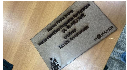
Figura1. Placa recortada a laser com o nome e a classificaçao da especie
