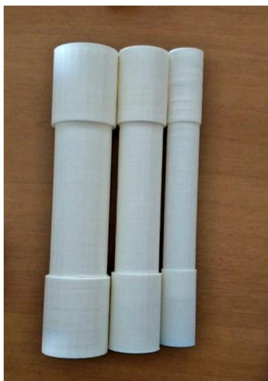
Figura 2. Tubulação 3D de 32mm, 25mm e 20mm
