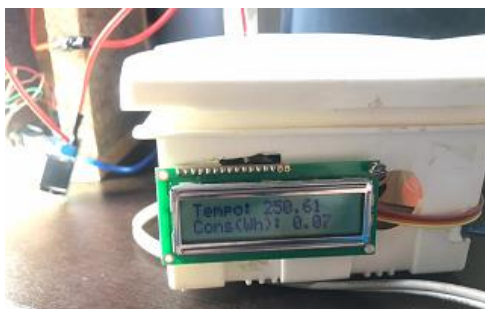
Figura 3 - Tela do controlador Tensão (V) / Corrente (I)
