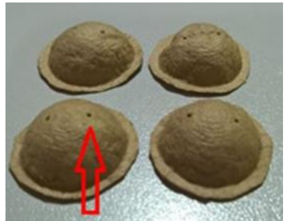
Figura 2. Cápsulas e furos a laser na calota para escape das vespas.
