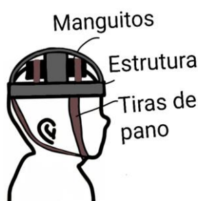
Figura 4. Desenho esquemático do sistema de fixação do capacete e dos manguitos. Fonte: Autores.
