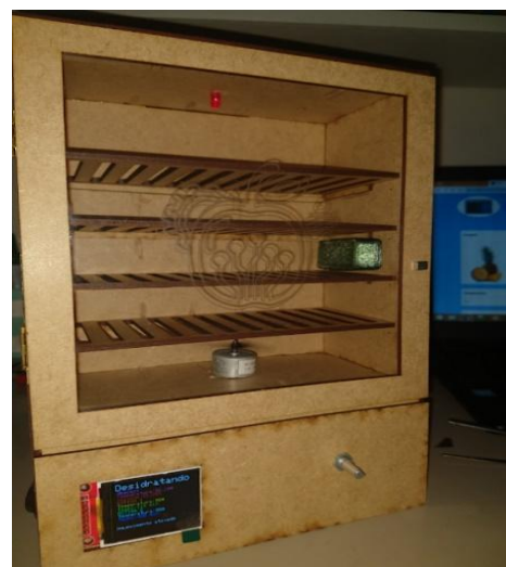
Figura 6– Estrutura do desidratador com acessórios,
