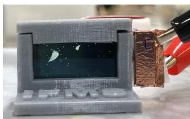
Figura 3 - Janela eletrocromática com cobre eletrodeposicionado.
