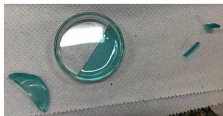
Figura 1 - Eletrólito pronto (gelatina + CuCl<sub>2</sub> 80mM).
