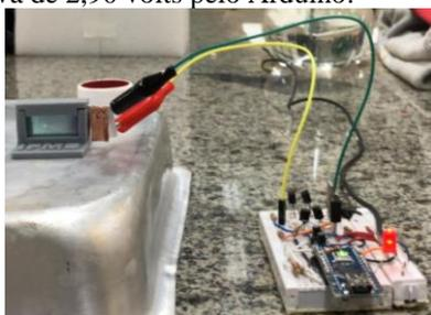
Figura 2 - Janela escurecendo com tensão fornecida pelo Arduino.
