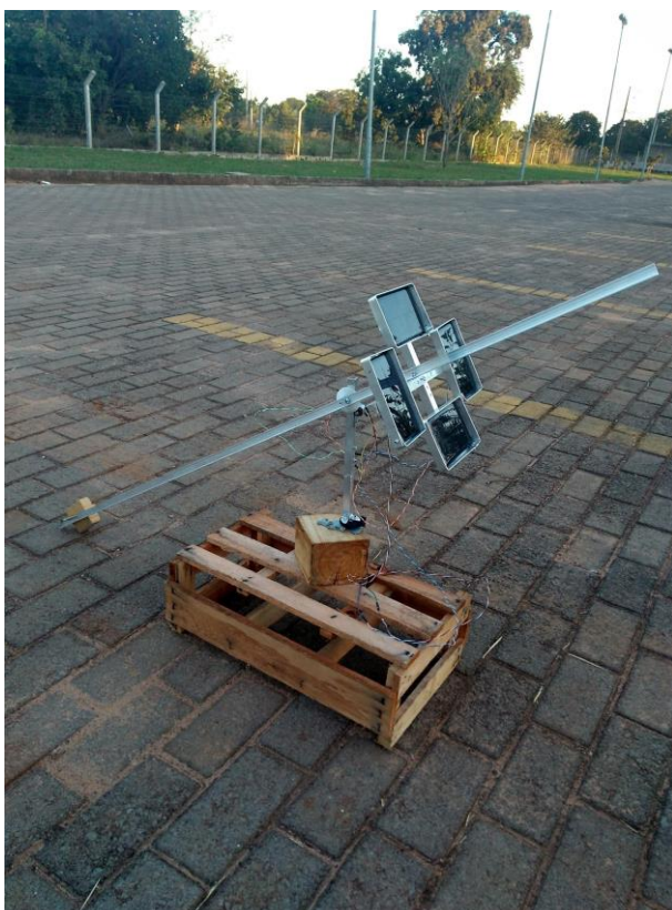
Figura 7. O protótipo do sistema de rastreamento solar com dois graus de liberdade.
