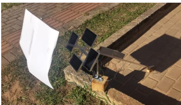
Figura 8. O protótipo do sistema de rastreamento solar com dois graus de liberdade exposto ao sol.
