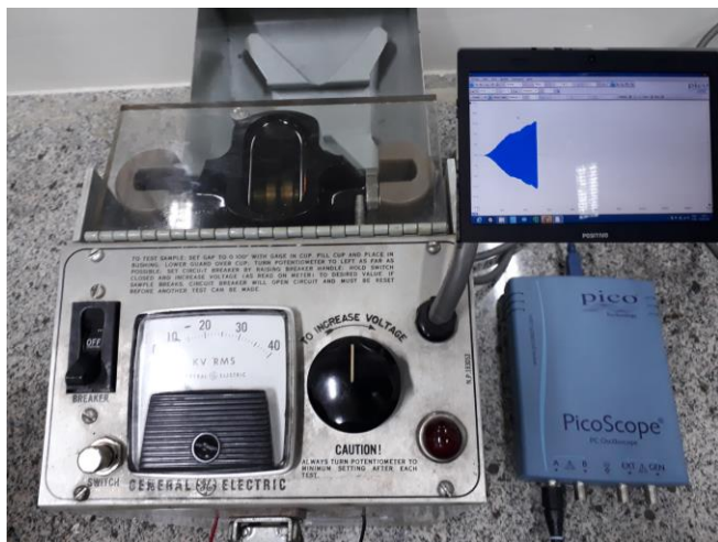
Figura 2. Cadinho preparado e montado no TOI (previamente calibrado) e com a tensão do primário monitorado por sistema de aquisição de sinais.
