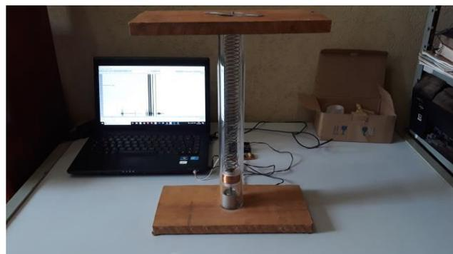
Figura 2 – Testes e calibração do sismômetro vertical
