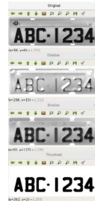
Figura 2. Pré-processamento das placas.
