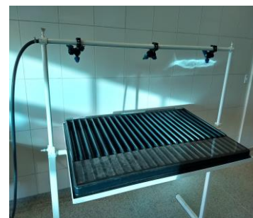
Figura 1: Suporte da mesa de distribuição para avaliação de pontas.
