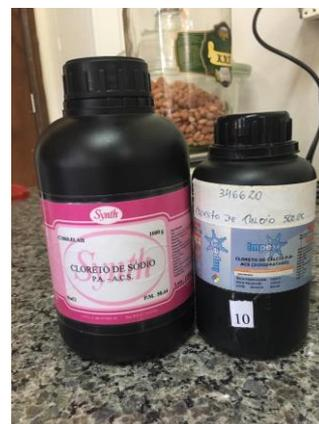
**Figura 2.** Sais utilizados para simulação da umidade relativa do ar.
