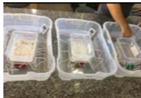
**Figura 1:** Caixas plásticas de 23 L e 2,5 L contendo sais e água para condicionar diferentes umidades relativas do ar.
