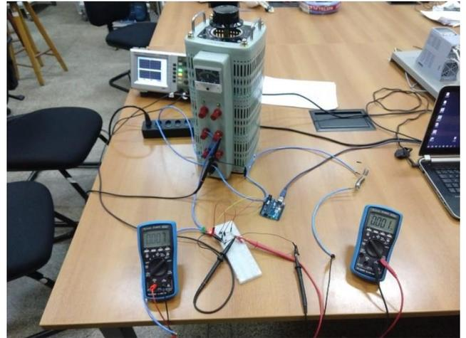
Figura 9. Calibração do sensor de corrente com um reostato, multímetros true rms, uma resistência de chuveiro e osciloscópio.
