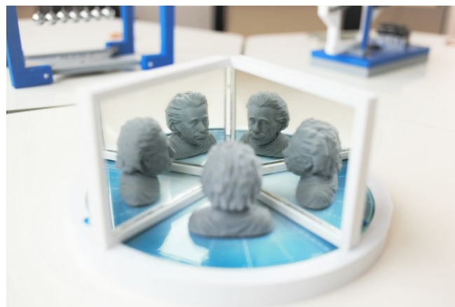
Figura 2. Associação de Espelhos Planos, um dos objetos produzidos durante o projeto. Fonte: autores.
