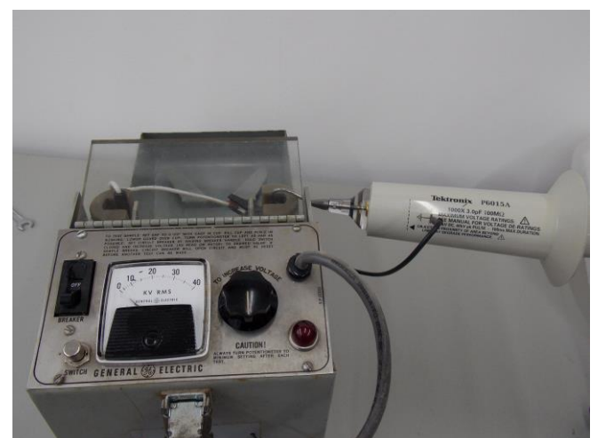
Figura 9. Processo de calibração usando-se o testador de rigidez dielétrica da General Electric (Insulating Oil Dielectric Strength Tester).
