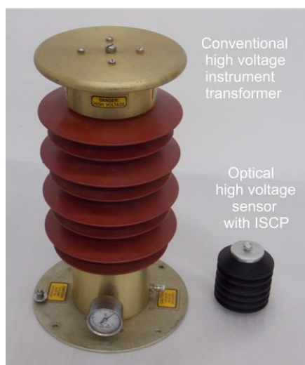
Figura 11. Comparação entre as dimensões de um transdutor convencional e o protótipo ISCP.
