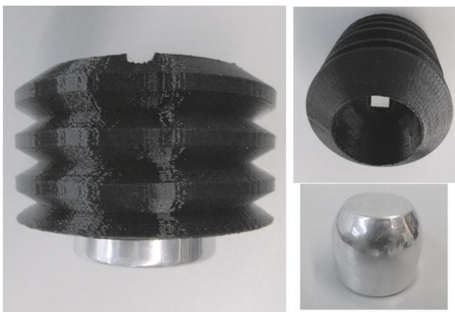
Figura 7. Protótipo ISCP: isolador e eletrodos.
