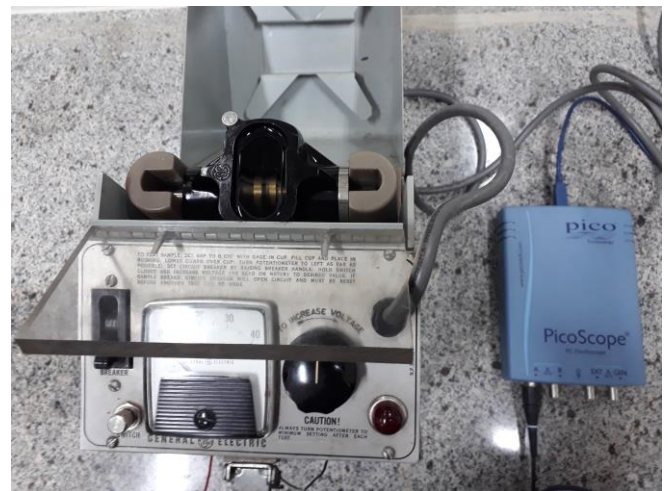
Figura 4. Cadinho preparado e montado no TOI (previamente calibrado) e com a tensão do primário monitorado por sistema de aquisição de sinais.
