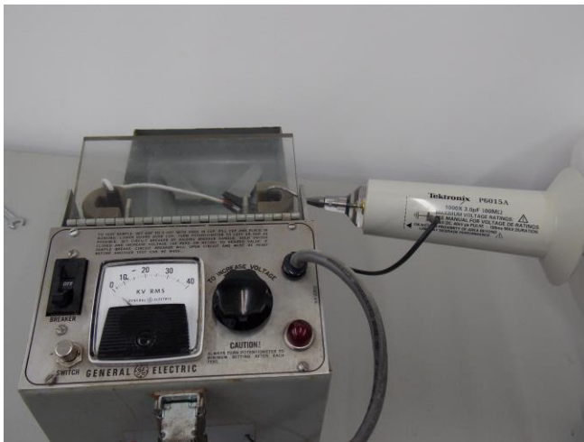
Figura 2. Processo de calibração usando-se o testador de rigidez dielétrica da General Electric ( Insulating Oil Dielectric Strength Tester ).
