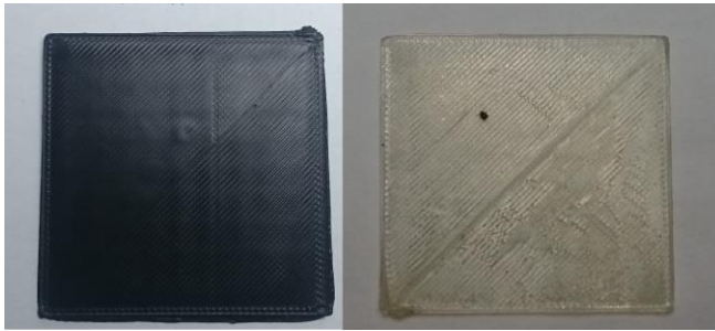
Figura 1. Corpo de prova 50 x 50 x 10 mm em Acrylonitrila butadieno estireno (ABS) nas cores preto e translúcido.
