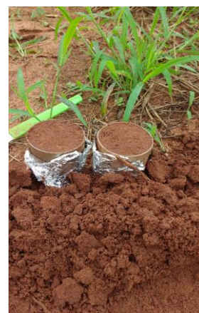
Figura 3. Coleta de solo para determinar densidade nas profundidades 0-10 cm e 10-20 cm.
