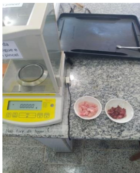
Figura 1. Balança e amostras de peixe na cápsula de porcelana à esquerda o músculo e à direita o trato digestivo.
