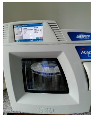
Figura 4. Digestão no forno micro-ondas utilizando o método one touch/ animal tissue .
