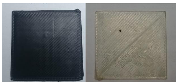
Figura 1. Corpo de prova 50 x 50 x 10 mm em Acrilonitrila butadieno estireno (ABS) nas cores preto e translúcido.
