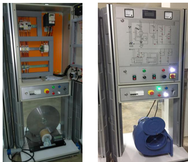
Figura 1. Bancadas didáticas com inversor de frequência e com partida suave respectivamente.
