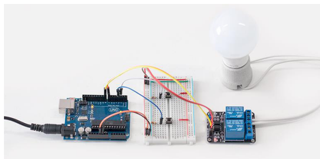
Figura 1. Arduino MEGA conectado a um relé.
