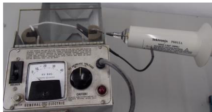
Figura 2. Processo de calibração usando-se o testador de rigidez dielétrica da General Electric ( Insulating Oil Dielectric Strength Tester ).
