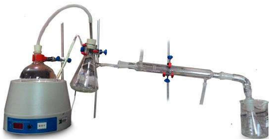
Figura 1. Sistema de destilação por arraste a vapor adaptada com os materiais existentes no laboratório. Fonte: Arquivo pessoal.
