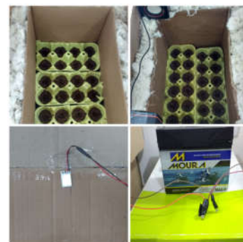
Figura 1. Câmaras acústicas, LED e bateria. (Fonte: Próprio autor)
