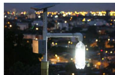
**Figura 2.** Protótipo do poste fotovoltaico confeccionado pelos alunos.
