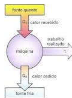
Figura 1. Esquema de máquina a vapor simples (Infoescola)
