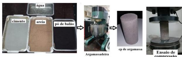
**Figura 1.** Metodologia na fabricação dos cps de argamassa e na obtenção dos resultados de resistência à compressão axial.
