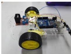
**Figura 1:** Carrinho Robô com tração “2WD”
