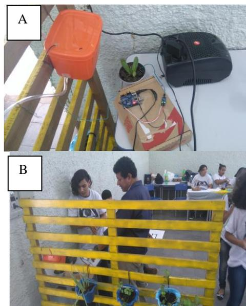
**Figura 1.** A) Placa de arduíno com a inserção do sensor de umidade e bomba e B) Disposição das plantas na horta.
