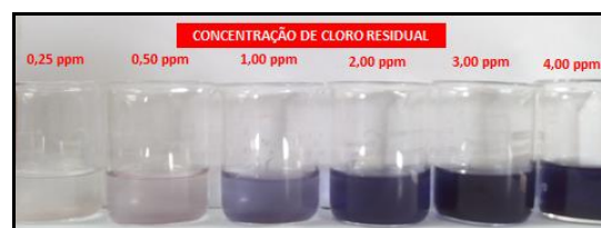
Figura 1. Alteração da cor da solução na determinação de cloro residual utilizando o reagente iodeto-amido
