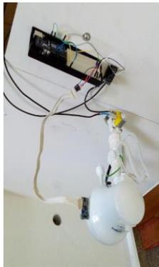
Figura1. Protótipo do Chuveiro Automatizado.
