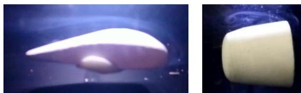
Figura 3. A esquerda, perfil com escoamento laminar. A direita, escoamento turbulento. Fonte: própria.
