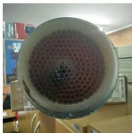
Figura 2. Feixe de canudos para criar um escoamento laminar. Fonte: própria.
