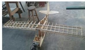
O projeto encontra-se em fase de fechamento da estrutura e revisão do sistema eletrônico, possibilitando a aplicação de conceitos básicos aerodinâmicos e de resistência dos materiais utilizados.
