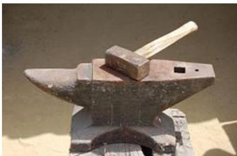
**Figura 1.** Martelo e bigorna. Equipamentos utilizados na forja manual, fonte: A cutelaria.com
