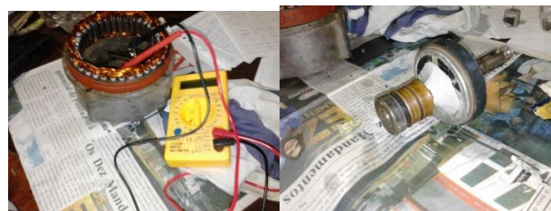
Figura 02: Base estrutural do alternador adaptado com ímãs permanentes. (Fontes pessoais).
