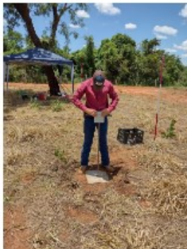
Figura 3. Levantamento da resistência do solo à penetração no IFMS - Campus de Nova Andradina/MS – Brasil.
