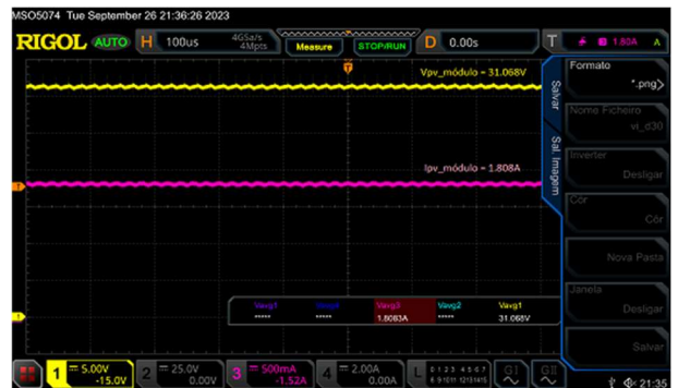
Figura 11. Tensão e corrente de saída do módulo. Fonte: Próprio Autor, 2023
