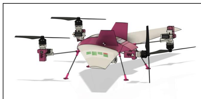
Figura 17. Protótipo com o rotor trazeiro em configuração de voo horizontal. Fonte: Próprio autor.
