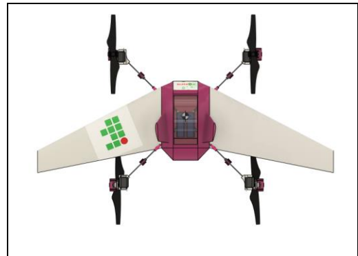
Figura 12. Modelagem do primeiro protótipo, com destaque para a disposição dos rotores e sua semelhança com os quadricópteros convencionais. Fonte: Próprio autor.
