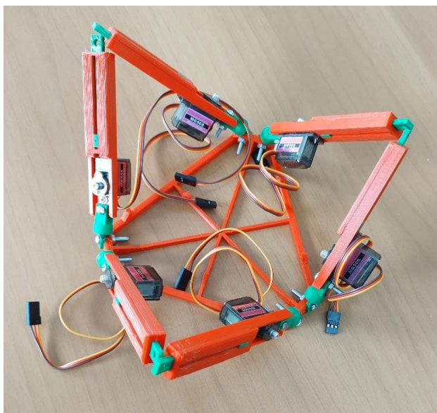
Figura 7. Atuadores fixados juntamente a base do sistema. Fonte: Próprio autor (2022).
