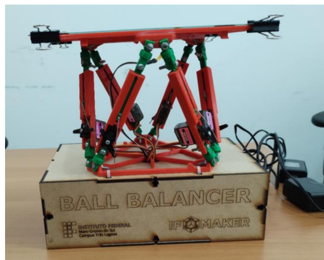
Figura 9. Sistema 6DOF ball balancer construído no IFMS. Fonte: Próprio autor (2022).
