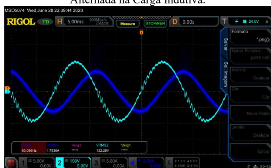
Figura 15 – Defasamento da Forma de Onda da Tensão e Corrente Alternada na Carga Indutiva.
