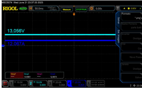
Figura 5 - Tensão e Corrente na Bateria.
