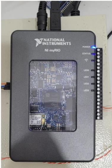
Figura 3. Myrio utilizado para aquisição dos sinais e controle do sistema.
