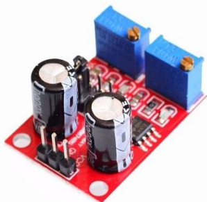
Figura 3. Módulo gerador de pulso em frequência PWM Ne 555 (de Baú da Elétrica, 2022).
