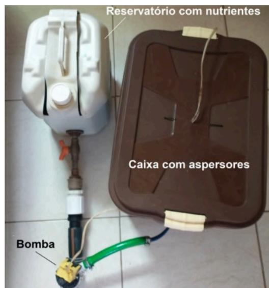
Figura 5. Sistema 1 montado.
