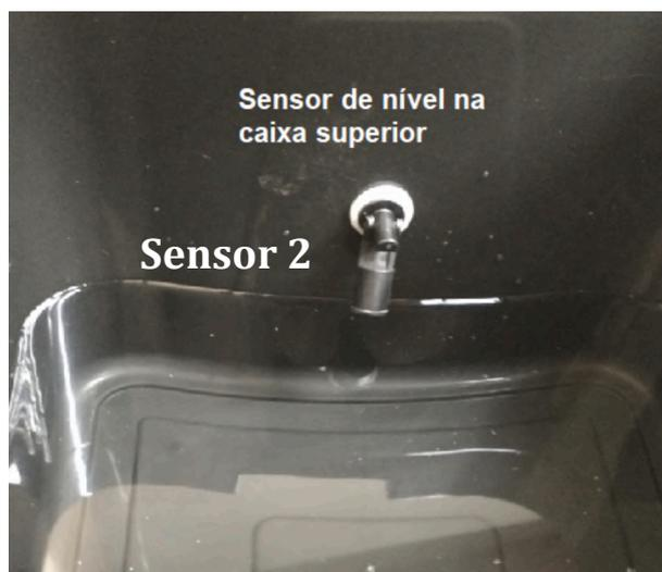
**Figura 11.** Sensores de nível do reservatório superior.
