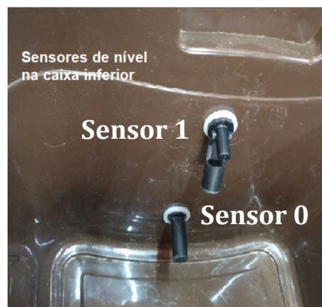
**Figura 10.** Sensores de nível do reservatório inferior.
