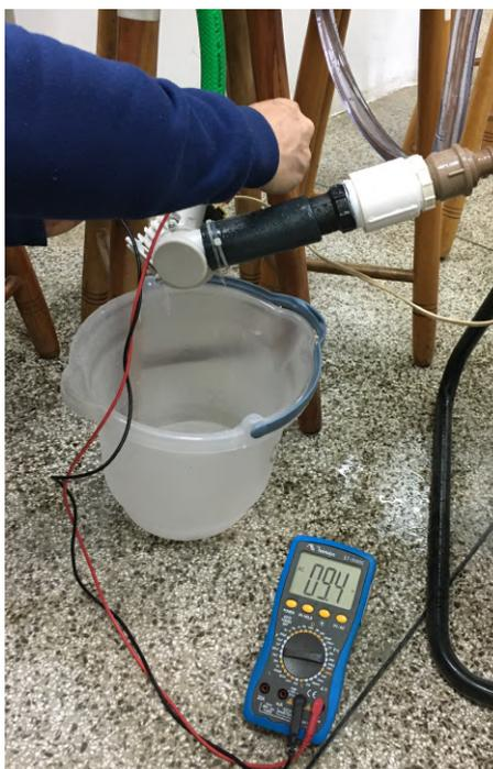
**Figura 17. Medição da corrente na bomba com o uso do circuito TRIAC.**
