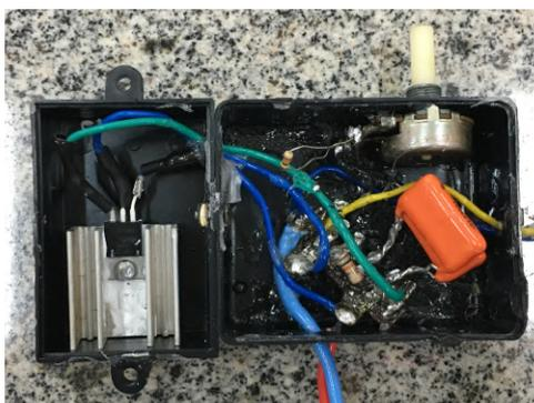
**Figura 7.** Circuito físico para o controle de velocidade da bomba.
